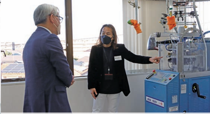
編み機は、突起のついたドラムが回ることでも数に数ある編針や糸を選択し編み込んでいく、まるでオルゴールのようです。
