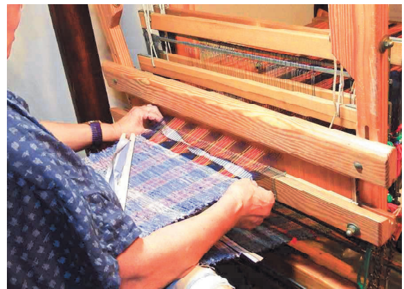
裂き布を横糸として通す (令和元年度さきおり教室)
